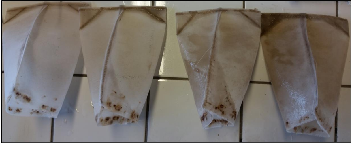
Figure 4 : Inhibition de la formation de biofilm sur les sacs à litière exposés aux ultrasons (deux premiers sacs en partant de la gauche) en comparaison aux sacs témoins non exposés (deux derniers sacs).
