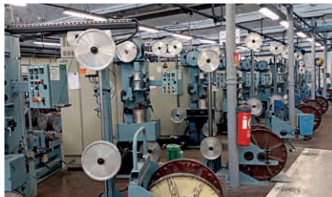
Les spinning machine (machines à filer) des ateliers de l'usine SiCab à La Ferté-Macé.
