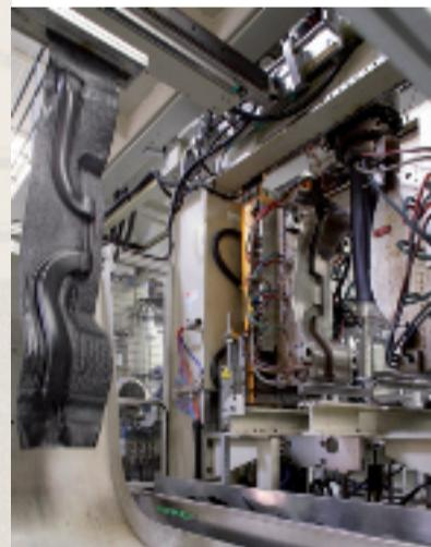
Ce procédé consiste à combiner la technique de l'extrusion avec celle du soufflage. Le tube extrudé (paraison) est enfermé dans un moule de soufflage (2 demi-coquilles ayant la forme désirée). La paraison présente un orifice à son extrémité, qui est pincée (là où sera l'ouverture finale du récipient). De l'air sous pression est ensuite insufflée dans la cavité par l'orifice afin de plaquer le tube déformable contre l'empreinte
